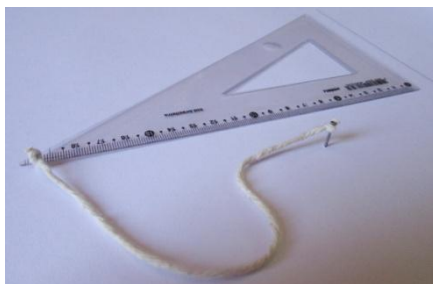
Figura 45: Barbante com extremidades fixadas no prego e no esquadro
